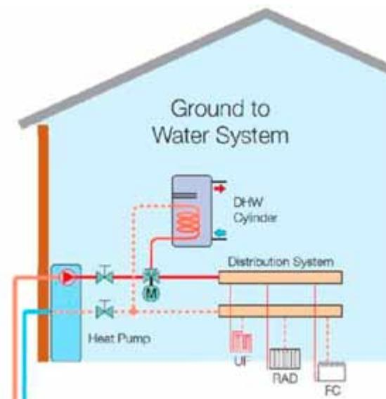
ABB. 3 Schema einer Erdwärmepumpe zur Versorgung von Bodenheizung, Niedrigtemperaturheizung oder Gebläsekonvektoren für den Wärme-/Kälte-Tausch [7]
