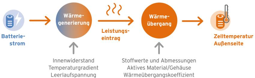
**Abbildung 3** Modellierung des thermischen Verhaltens einer Batteriezelle
