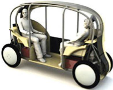
**Abbildung 9** Ergonomische Auslegung eines 2-Sitzers mit gegenüberstehenden Passagieren
