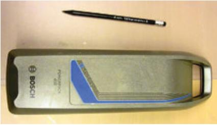
**Abbildung 4** Bosch Li-Ion-Akku „Powerpack 400“ für Bosch Pedelecs. 36 V, 11 Ah, 400 Wh (Quelle: Wikimedia Commons, [https://commons.wikimedia.org/wiki/File:Bosch\\_Pedelec\\_Battery.JPG](https://commons.wikimedia.org/wiki/File:Bosch_Pedelec_Battery.JPG), Lizenz WTFPL)
